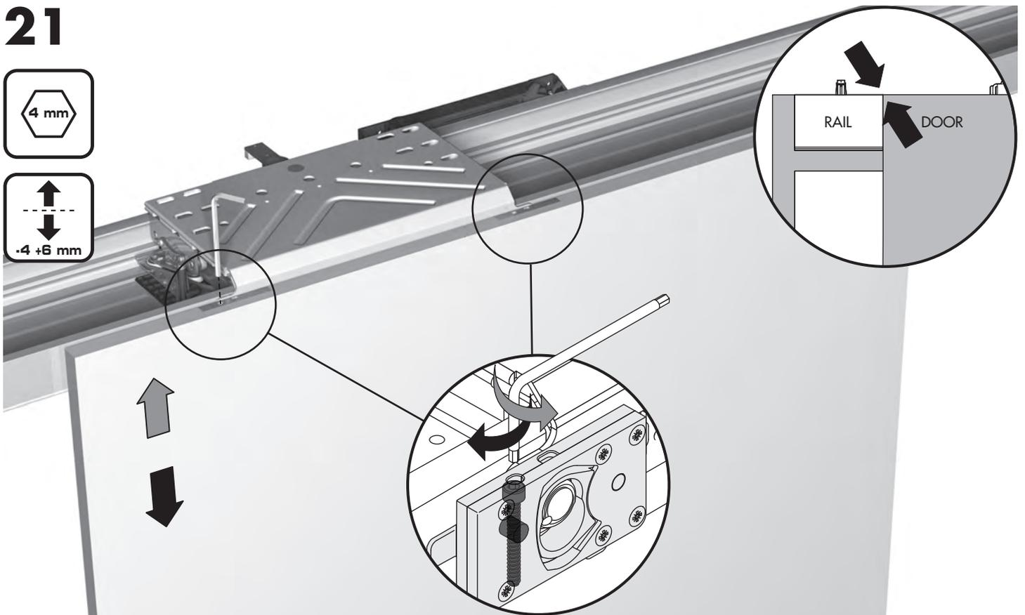
**Chiudere l'anta. Regolare il livello dell'anta portandolo a filo del binario superiore.**
