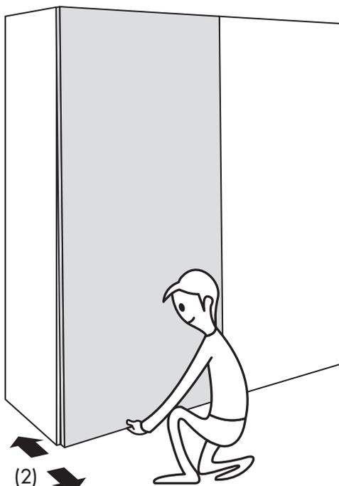
**Scuotere (2) leggermente l'anta nella parte inferiore in questo modo lo stop inferiore si allineerà in modo automatico allo stop superiore.**
